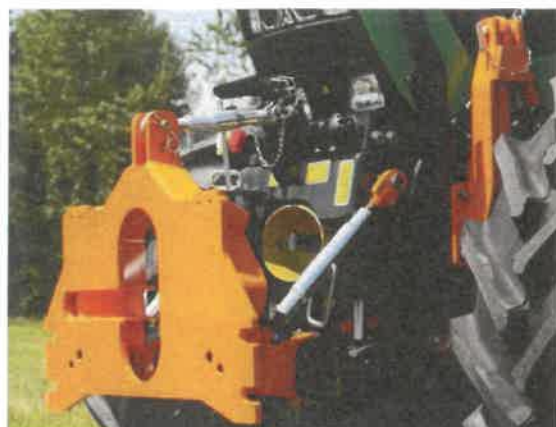
Starrer Anbau mit Achsabstützung
